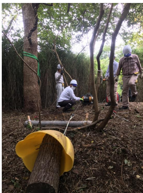
斜面の丸太材引揚げはスキッドコーンを付けてスムーズに引き揚げられる
