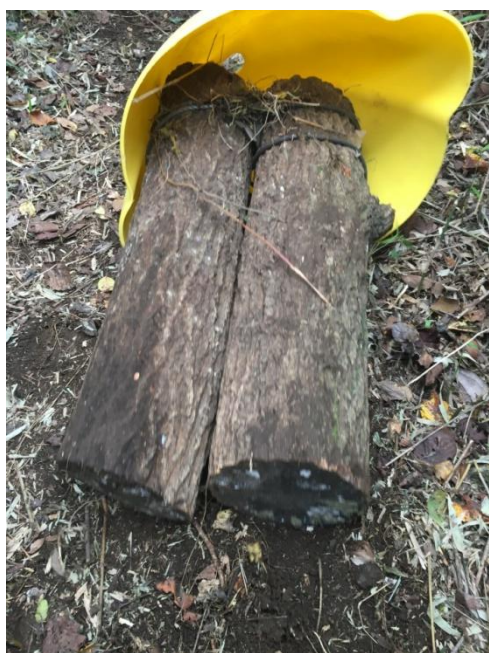
斜面の丸太材引揚げはスキッドコーンを付けてスムーズに引き揚げられる
