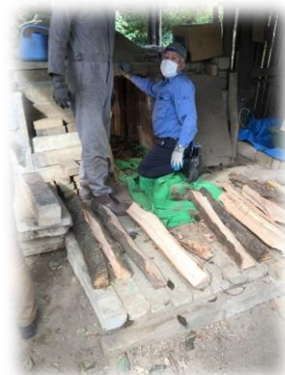
本窯への炭材装入/立て込み 敷き木→炭材(元口を上にして)→上げ木 2020/11/7
