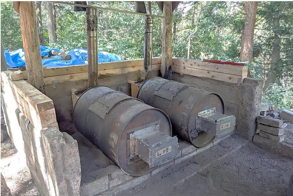
前面火入れ口側へ傾斜を付けて設置。煙突部の養生もバッチリ！
