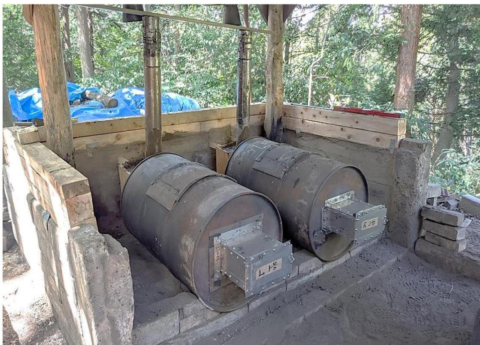
前面火入れ口側へ傾斜を付けて設置。煙突部の養生もバッチリ！
