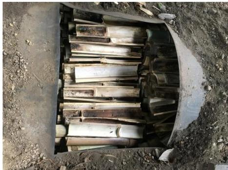
集められた竹はドラム缶に納まる長さに切って、なたで割ります。竹の炭材はドラム缶の中に横積みで挿入します。
